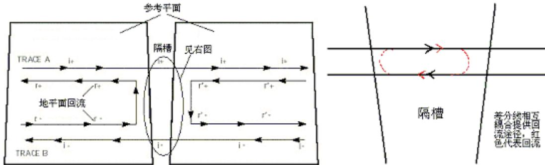
图1-8-17 不连续的地平面上的差分信号回流
