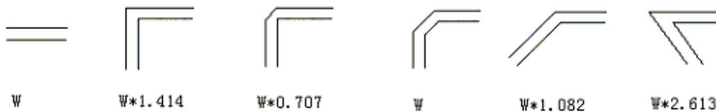
图1-8-13 不同角度走线的拐角线宽变化
