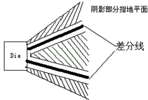
图1-8-19 封装中的CPW结构
