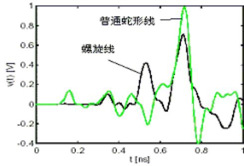
图1-8-22 螺旋走线和普通蛇形线的比较
